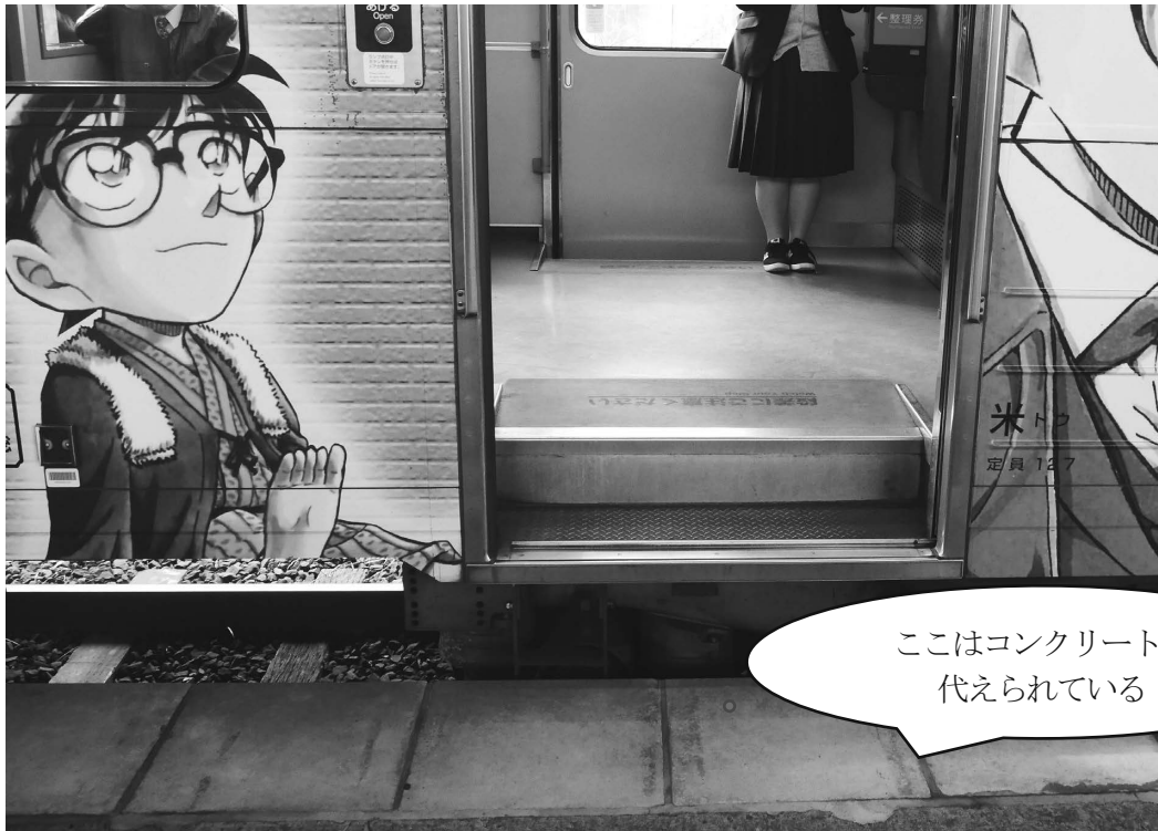
写真 13 車両の中の段差は 20 cm ほどであるからホームとの段差 25 cm 以上あることがわかる
